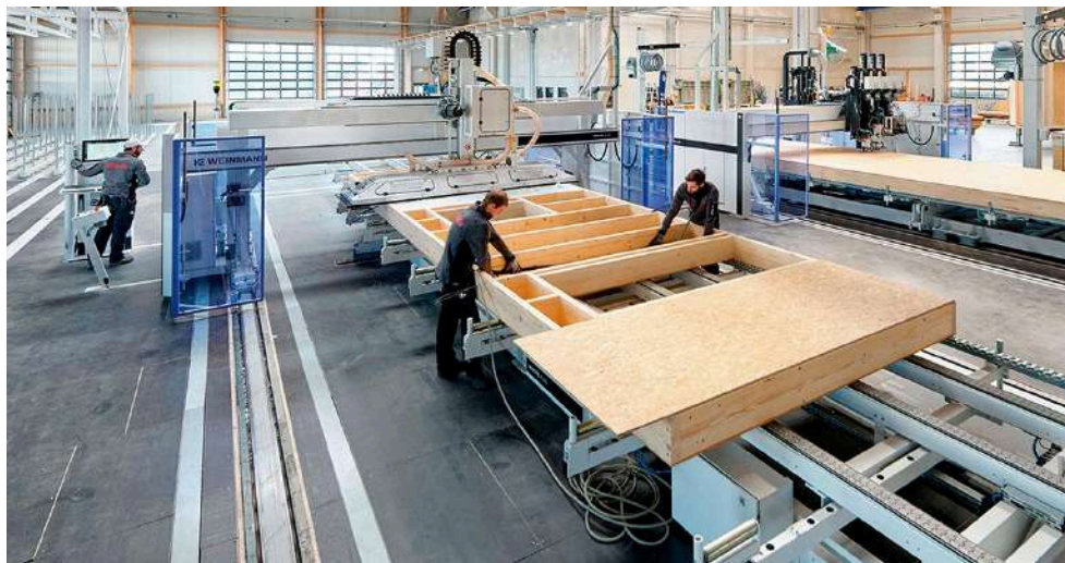
Fábrica de montaje de entramado ligero para muros, fachadas y forjados
